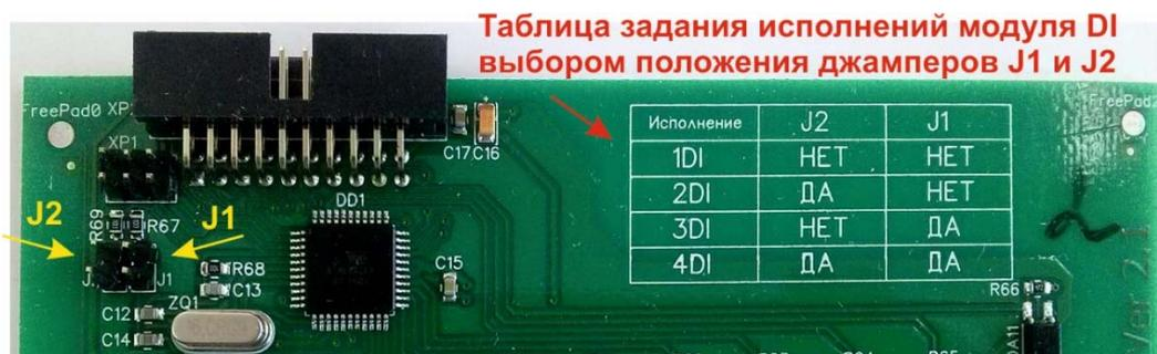
Рисунок 19 – Таблица задания исполнений модуля *DI* и места установки джамперов *J1* и *J2*
