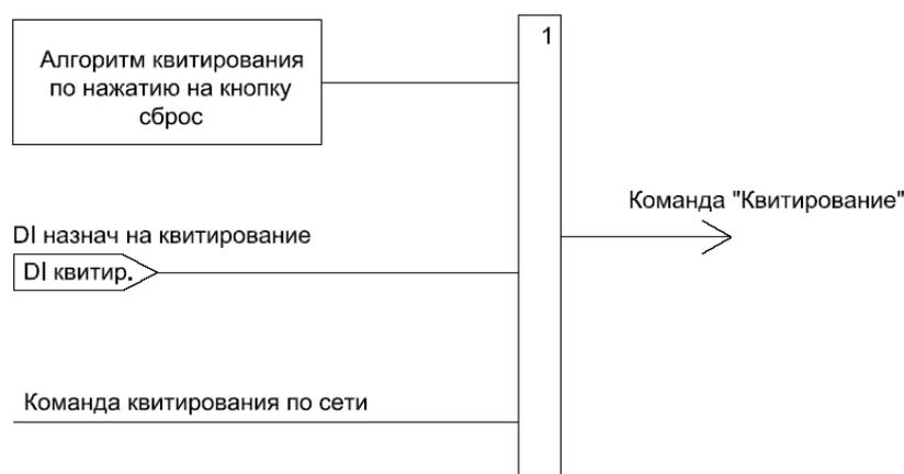
Рисунок 93 – Алгоритм работы функции квитирования
