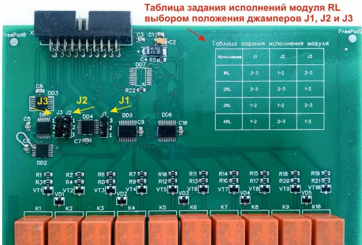
Рисунок 22 – Таблица задания исполнений модуля *RL* и места установки джамперов *J1*, *J2* и *J3*
