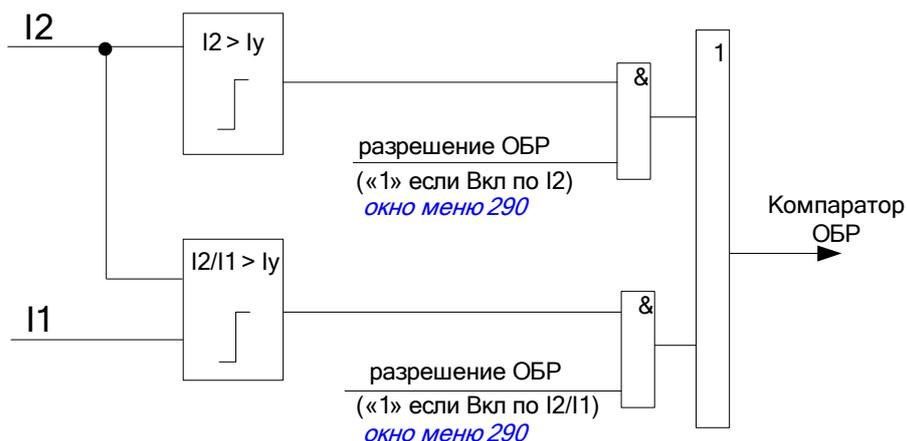
Рисунок 63 – Функциональная схема логики компаратора ОБР
